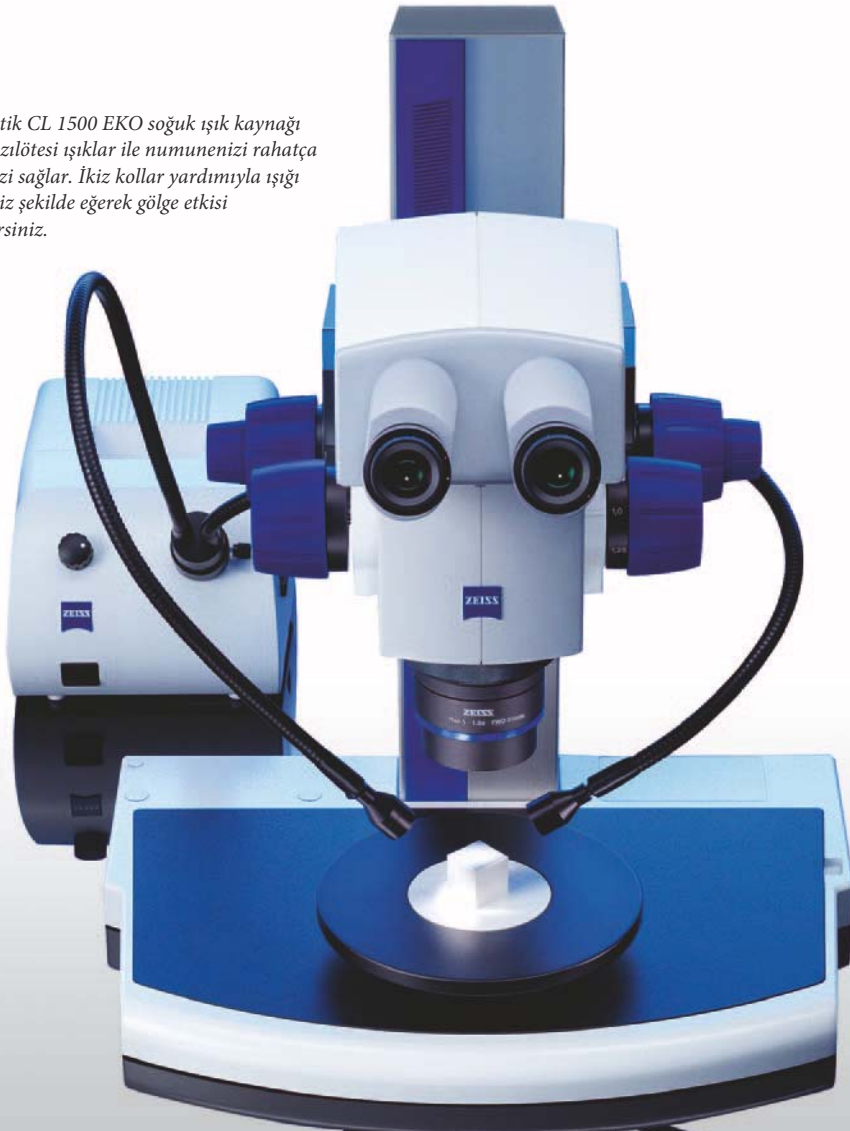
SMD-Tahta üzerinde Beyaz lehim Farklı ışık kılavuzları ile yansıyan ışık a. Yanal alanda doğrusal yarık ışık b. Fiber-optik dairesel aydınlatma sayesinde 360° derece dönebilen yansıyan ışık c. Parlamaı en aza indirmek için cihaz ile birlikte polarize ışık filtresi vardır. Objektif: Plan S 1.0x Büyütme: 15x
